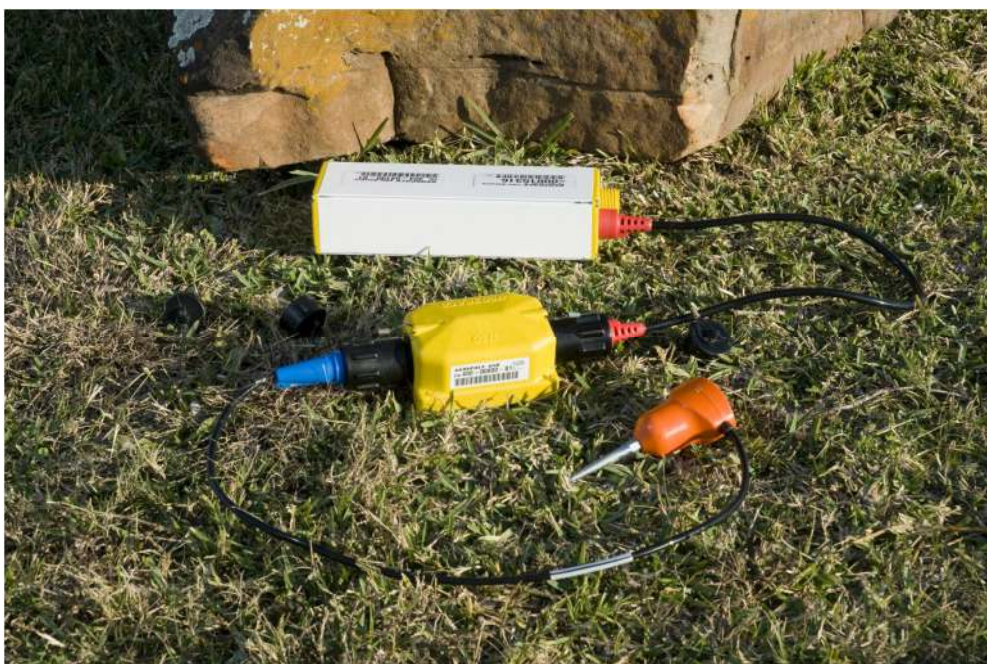
Kihelyezett terepi mérőpont, geofon és adatgyűjtő elektronika
