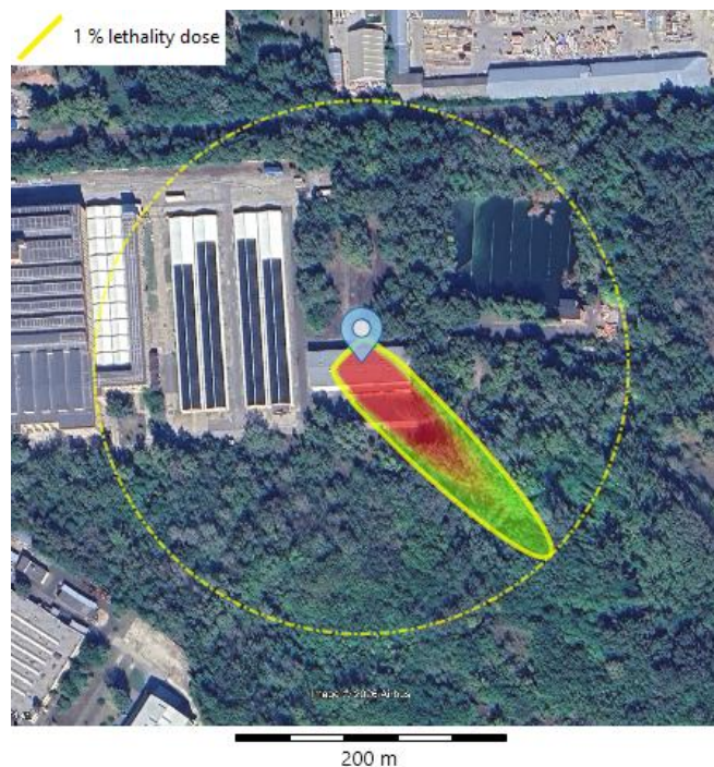
15. ábra: A 135/1. raktártűz esetén kikerült NO 2 terjedése következtében létrejövő 1%-os halálozási kontúr (F1 légkör állapot)
