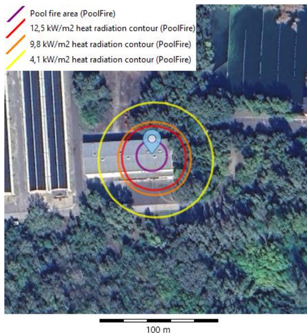
3. ábra: Tetrahidrofurán kikerülése esetén keletkező tócsatűz hatásövezetei
