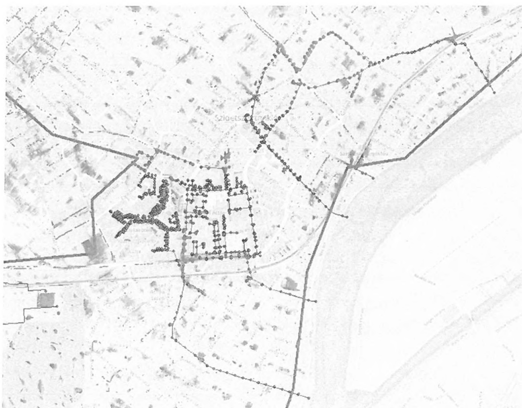
1.30.Ábra Felhőszakadás elemzés eredményeként és pirossal jelölve a kapacitás problémákkal rendelkező cső szakaszok és aknák (DHI Hungary Kft, 2018)
